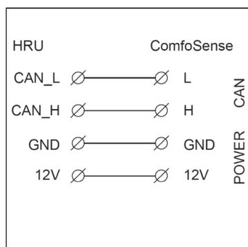
La longueur maximale du câble entre le ComfoSense C et l'unité ComfoAir Q récupérateur de la chaleur ou ComfoSplitter avec alimentation est de 50 mètres.
