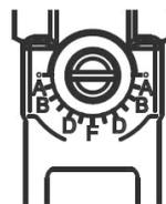
9/ Fermer la vanne du bas de la station et arrêter la pompe de remplissage lorsque la pression dans le circuit atteint 3,5 bars. Fermer ensuite la vanne du haut. Mettre le débitmètre en position ouverte.
